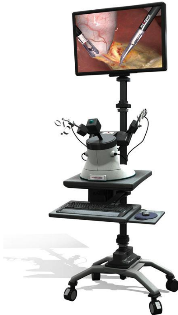
Hình 16.2 LAP Mentor™ Express là một hệ thống đào tạo nội soi không haptic được cung cấp với chi phí thấp hơn. Có sẵn tháp di động hoặc tùy chọn, bao gồm các cài đặt màn hình cảm ứng
