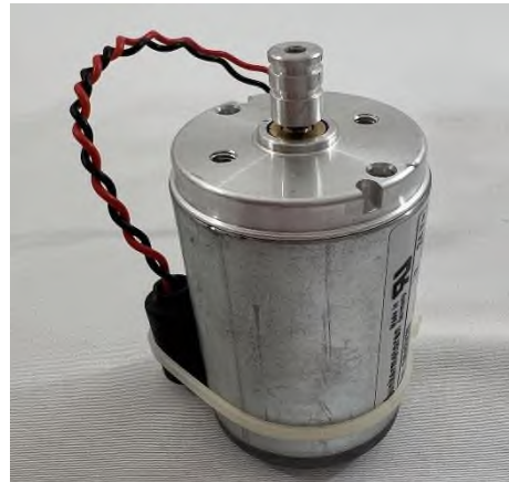
Hình 2a: Động cơ DUNKERMOTOREN Type GR42X25, 3600RPM 24V/6.5A, SNR 88427 01780
