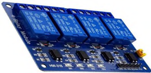
Hình 5. Hệ thống relay điều khiển
